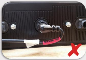
Eine zu hohe Spannung im Kabelstrang führt zu Spannungen in den Endverbindungen und der Dichtfläche. Umleitung vorgeschlagen.
