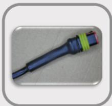
Gegebenenfalls die Schrumpfschlauchmuffe über den ersten erhabenen Grat ausrichten und mit dem zweiten bündig abschließen
