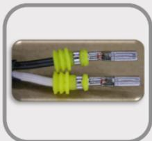
Crimpen Sie die Kontakte an die Kabel, stellen Sie sicher, dass das Kabel mit dem Kontakt ausreichend freigelegt und die Kabeldichtung angebracht ist
