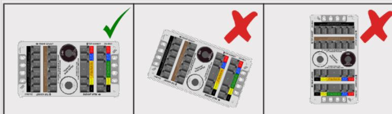
Die Stecker müssen mit Dichtungen in der richtigen Position korrekt verriegelt sein.
