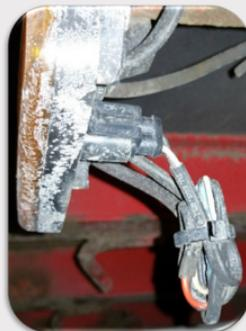
Bitte stellen Sie sicher, dass der richtige Stoßverbinder mit Schrumpfschlauch für den Kabelquerschnitt (mm<sup>2</sup>) und ein Schrumpfschlauch für die Abdichtung gegen den Außenmantel des Kabels verwendet wird.
