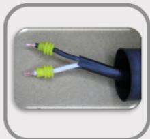
Stecken Sie den Schrumpfschlauch und die Gummi-„Kabeldichtungen“ auf
